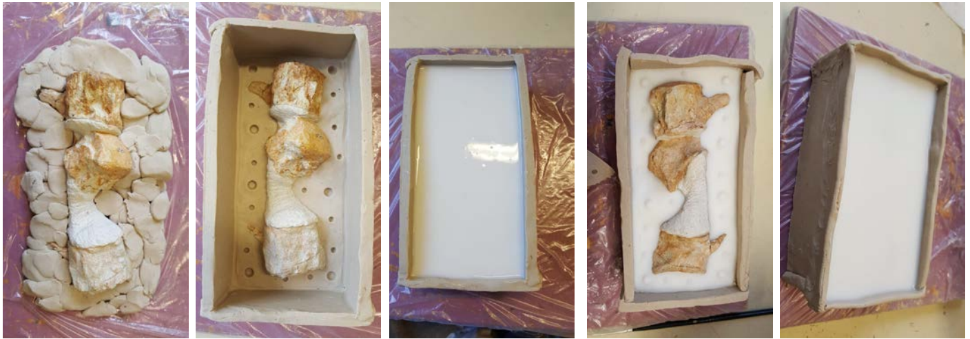
Figure 3. Étapes de la construction d'un moule en silicone en deux parties (vertèbres en connexion de mosasaure). De gauche à droite : fond en plastiline ; fond terminé, avec des clefs de joints, et muré ; silicone coulé pour une première moitié du moule ; première moitié du moule en silicone sèche et retournée ; silicone coulé pour seconde moitié.
