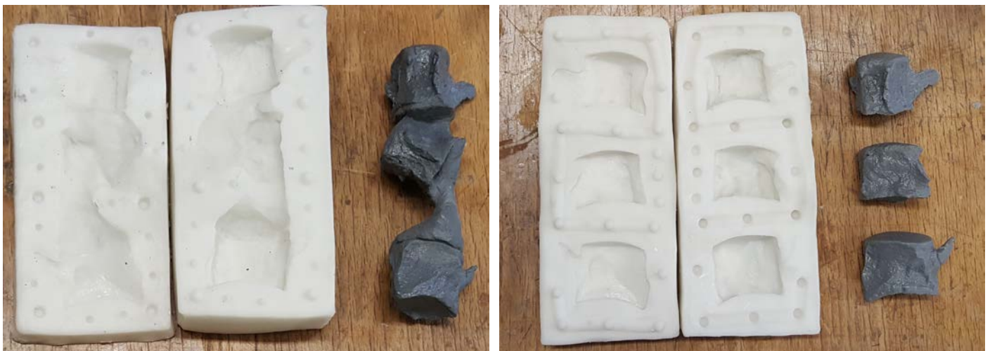
Figure 5. Moules en silicone et tirage en résine de trois vertèbres de mosasaure. À droite, en connexion. À gauche, isolées.
