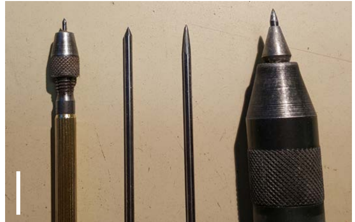
Figure 1. Outils de préparation mécanique. De gauche à droite, aiguille montée sur porte-aiguille, aiguilles libres, micro-percuteur à air propulsé. Échelle = 1 cm.
