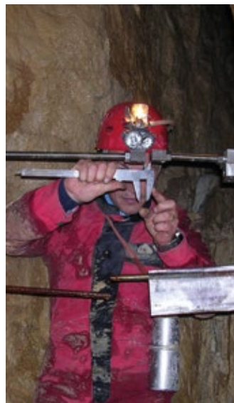
Suivi des fissuromètres de la Cuvée des Ours par le Spéléo-club de Savoie. Photo : F. Hobléa
